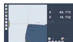
مقاطع پویا به طور خودکار تنظیم میشود، با حرکت محور های X و Z، ابزار های برشی را میتوان به سرعت از طریق مقاطع پویا را اندازه گیری کرد
