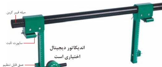
اندازه گیری قطر داخلی، کمینه قطر است 220mm
