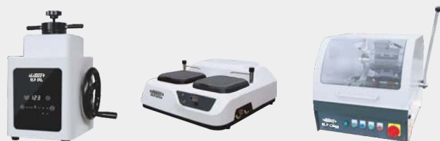
پرس های نصب
