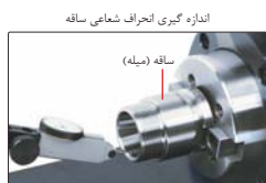
اندازه گیری انحراف شعاعی ابزار برش
