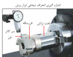
اندازه گیری انحراف شعاعی ابزار برش
